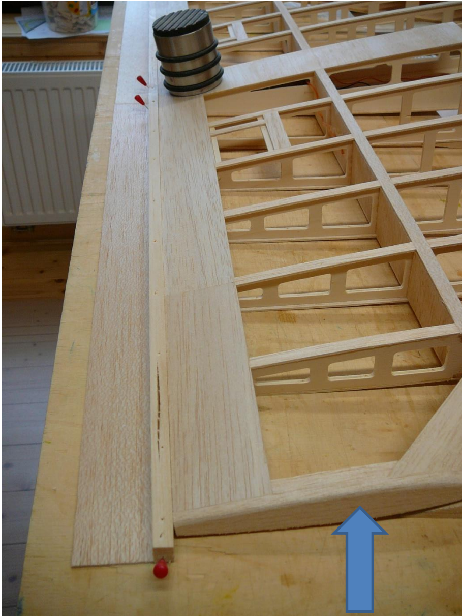
Randbogen Balsa 8x35x180mm ankleben und verschleifen.
